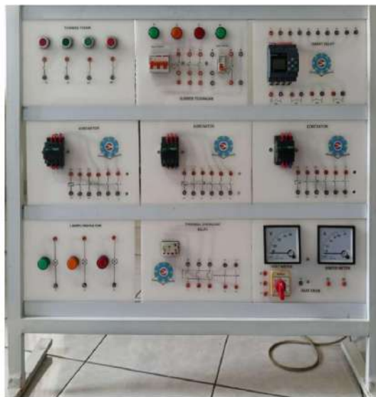
Gambar 2. Tampak Depan Media Pembelajaran Trainer Programmable Logic Controller (PLC) Siemens Logo! Sebagai Media Pembelajaran
