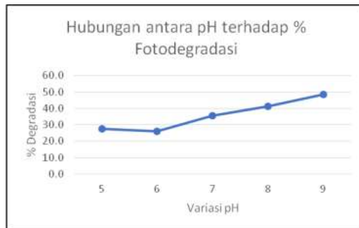
Gambar 5. Grafik hubungan antara pH campuran terhadap persentase degradasi zat warna Remazol Blue
