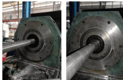
Gambar 8. Proses pelepasan dan pemasangan mechanical seal
