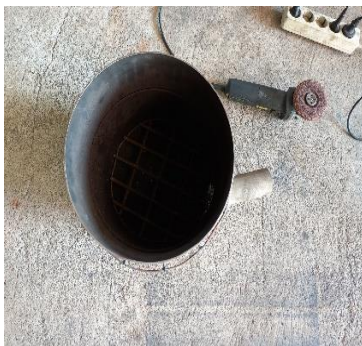
Gambar 4. Pembuatan body tungku
