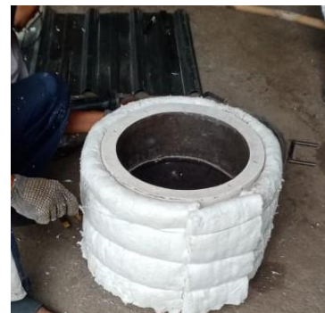
Gambar 5. Pelapisan ceramic fiber pada bagian body tungku
