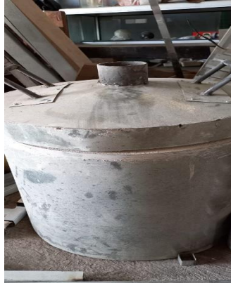
Gambar 6. Tungku peleburan logam
