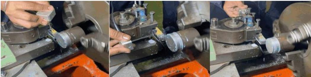
Gambar 1. Proses Pengukuran dengan diamter material 1.25 inci.
