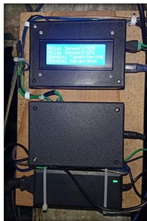
Gambar 6. Controller Automasi Irigasi, Tampilan LCD berisi Informasi Nilai Sensor, Kondisi Tanah (Kering/Basah) dan Kondisi Keran (On/Off)
