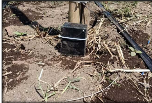
Gambar 5. Sensor Soil Moisture YL-69 untuk Mengukur Kelembapan Tanah
